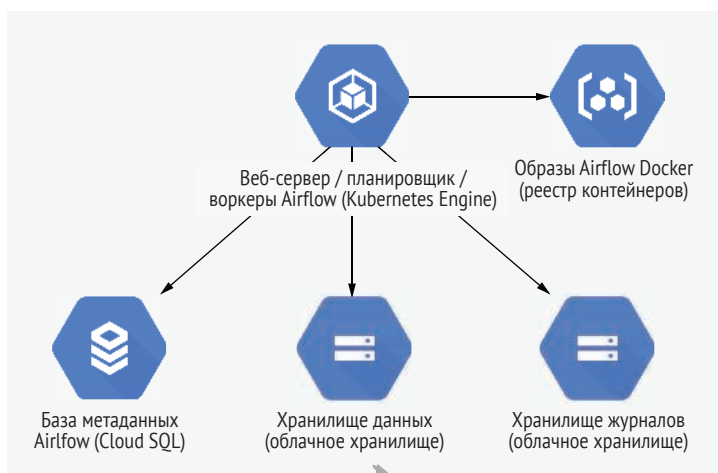
Рис. 18.2 Сопоставление компонентов Airflow с GCP в развертывании Airflow на базе Kubernetes
