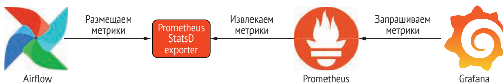
Рис. 12.16 Программное обеспечение и шаги, необходимые для сбора и визуализации метрик из Airflow. Prometheus собирает метрики, а Grafana визуализирует их в дашбордах. Экспортер переводит метрики StatsD в формат метрик Prometheus и предоставляет их Prometheus
